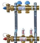
Den Verteiler gibt es in verschiedenen Ausführungen je nach Anzahl der erforderlichen Heizkreise. Er besteht jeweils aus zwei korrosionsfreien Verteilerschienen aus Messing. Diese sind auf schallgedämmten Haltebügeln vormontiert, die an insgesamt vier Punkten an der Wand oder auf dem Boden befestigt werden können.
